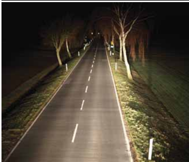
Distribuição de luz típica e a temperatura de cor de um feixe de luz com lâmpada de halogênio Standard.
