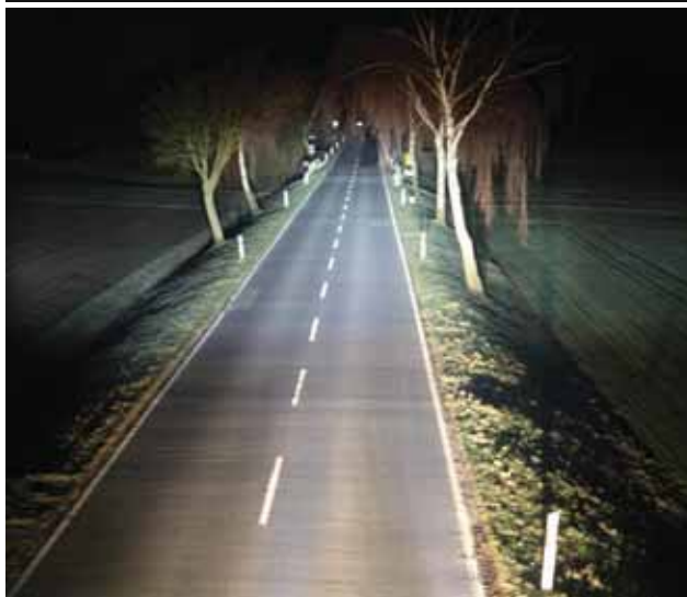
Distribuição de luz típica e a temperatura de cor de um feixe de luz com cápsula HID.
